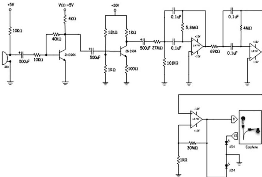
Fig. 47.1 Detector circuits
